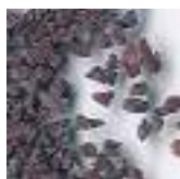
A Corindón recocido y con recubrimiento cerámico
