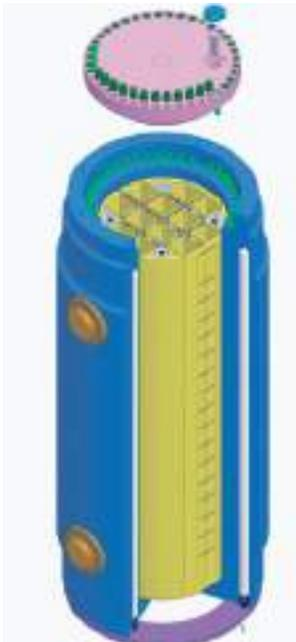
※ COFRE 6: un contenedor con blindaje para transporte y almacenamiento de materiales radiactivos.
